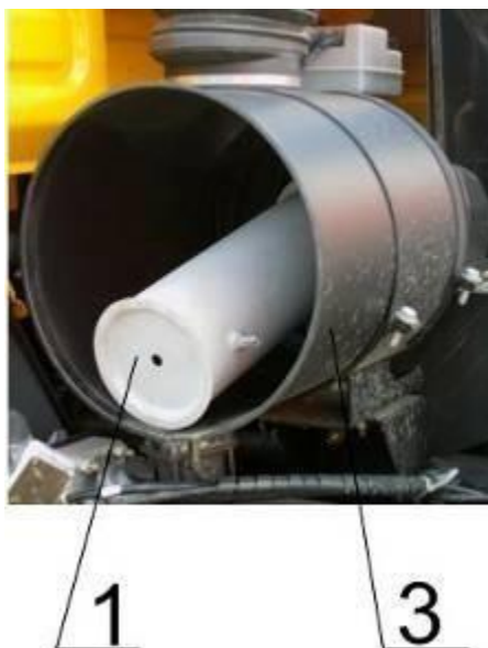
Рисунок 5. Установка приспособления для проверки герметичности впускного тракта с заглушкой БГВТ 04.000
