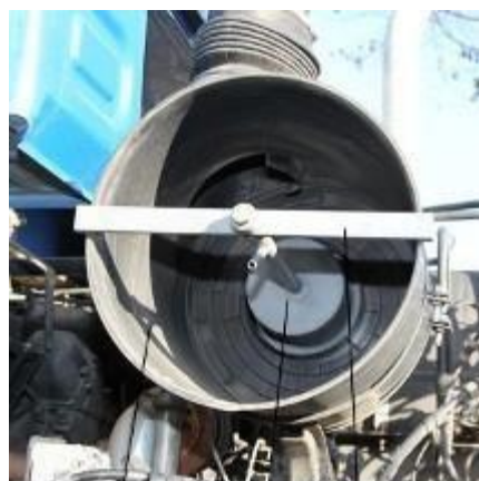
Рисунок 3. Установка приспособления для проверки герметичности впускного тракта с заглушкой БГВТ 02.000
