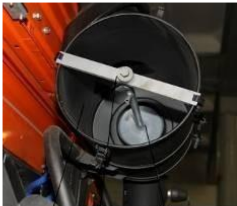
Рисунок 4. Установка приспособления для проверки герметичности впускного тракта с заглушкой БГВТ 03.000
