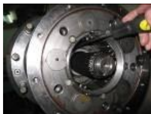
4. Отгибание ушка стопорной шайбы
