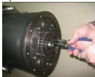
3. Снятие стопорного кольца и солнечной шестерни
