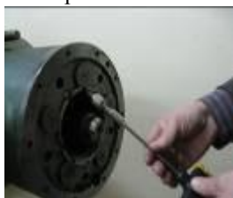
5. Откручивание стопорного болта
