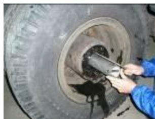
6. Регулировка подшипника ступицы
