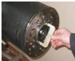
1. Отворачивание гайки полуоси
