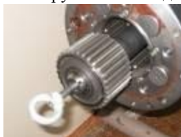
2. Выдвижение полуоси на выводя из зацепления с механизмом блокировки
