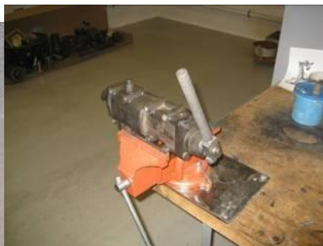
Проверка включения передач
