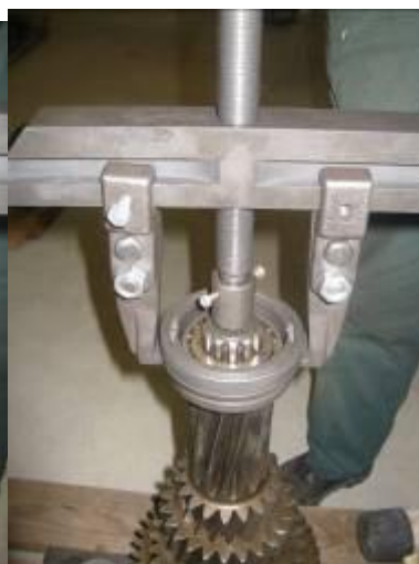
Снятие перед.подш. Снятие заднего подш.
