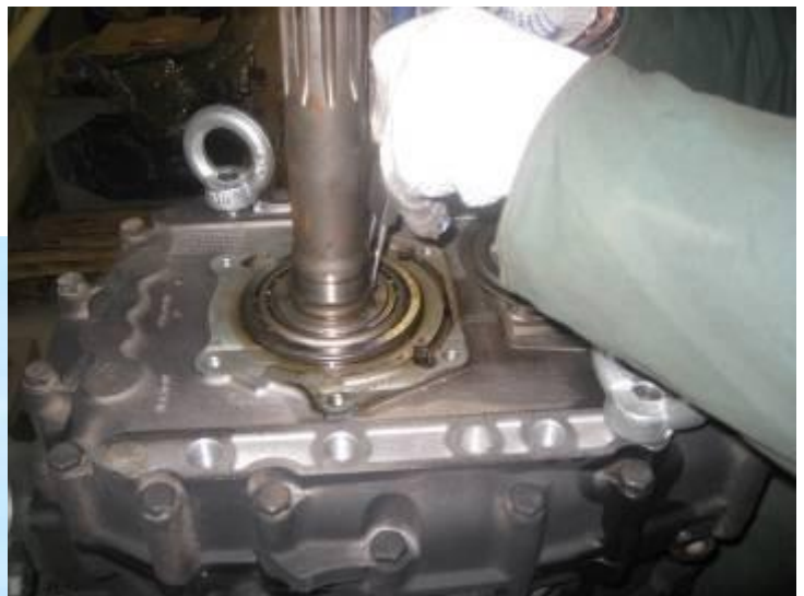
Снятие стопорного кольца И801.22.000
