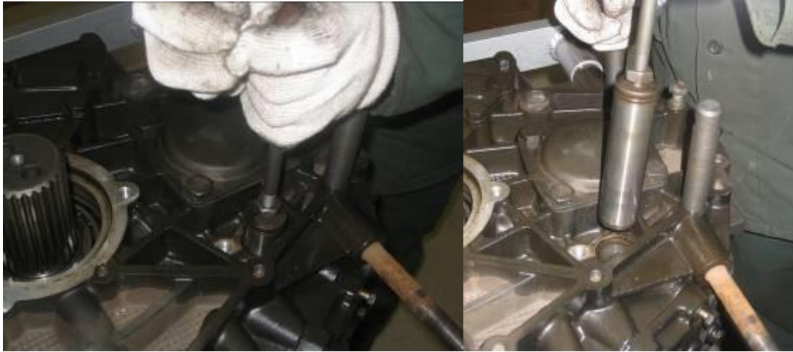
Рис.13. Снятие оси шестерни заднего хода.
