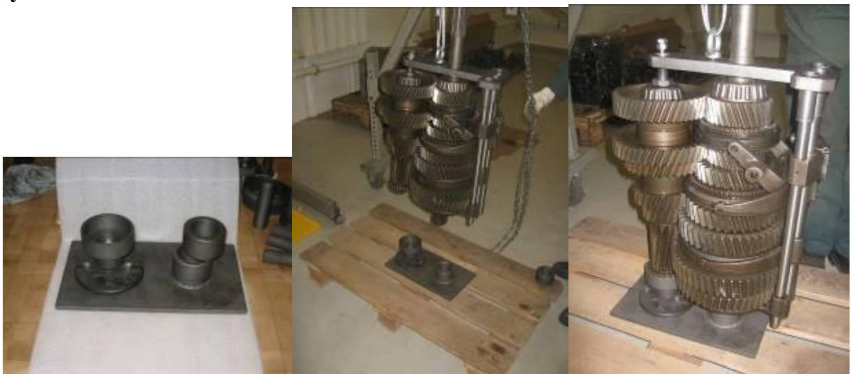
Рис.17. Базирующий элемент 1X56 138 140 СБ и установка на него валов со штоками.
