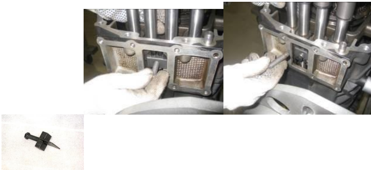
Рис.15. Фиксатор И801.103.000 СБ и его установка
