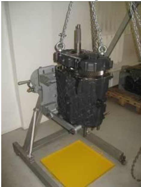
Рис.14. Снятие крышки корпуса КП.
