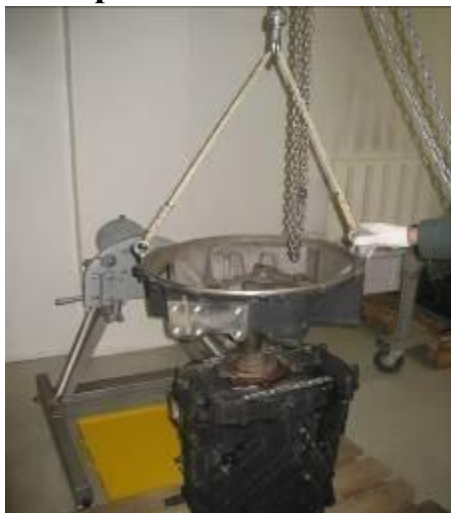
Рис.5 Рым- болты 1X56 136 564 с капроновым канатом
