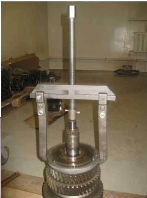
Рис.20.Захваты И801.98.000 и снятие каретки 3/4 передачи
