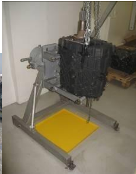
Рис.3 Установка КП на станд ЛПН-
