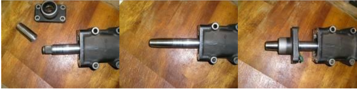
Рис.30. Защитная втулка 1X56 137 134 , крышка и корпус механизма переключения передач
