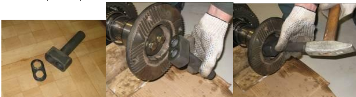
Рис.25. Насадка 1X56 136 471 и шайба Установка стопорной шайбы приводного фланца
