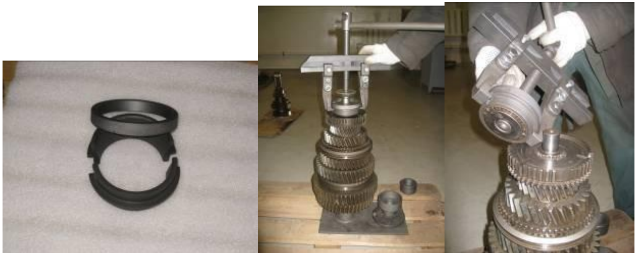
Рис.18. Захваты И801.95.000 и снятие подшипника
