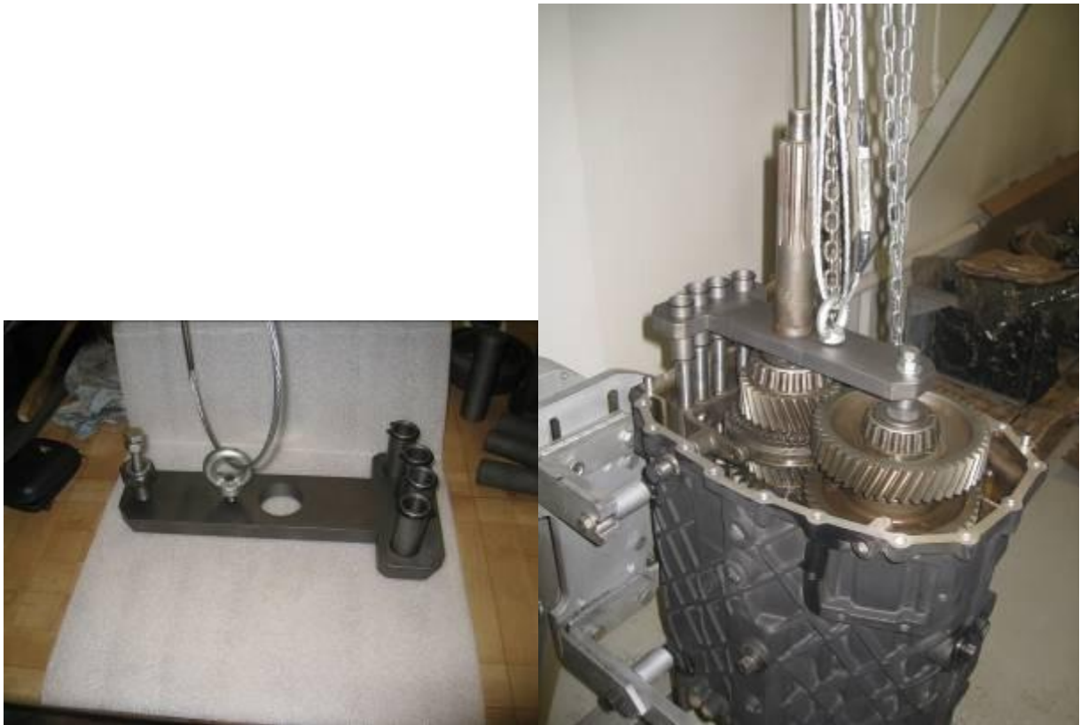
Рис.16.Подъемное устройство и его установка
