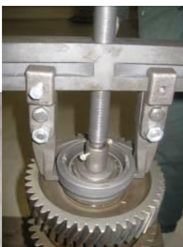
Снятие перед.подш. Снятие заднего подш.
