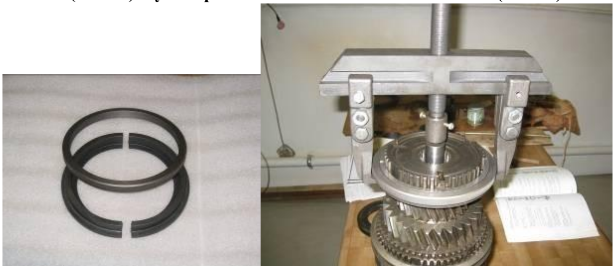
Рис.19.Захваты И801.99.000 и снятие каретки 5/6 передачи
