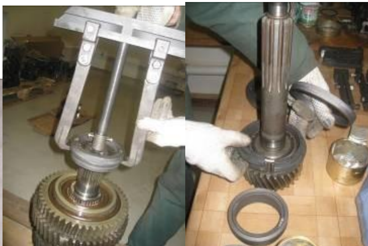
Снятие задн. подш. вторич. вала Снятие подш. первич. вала
