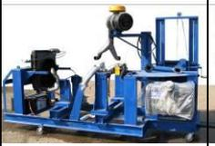
СОД.1001.0000.000                  | Стенд для горячей обкатки двигателя                                            | 387587     |
